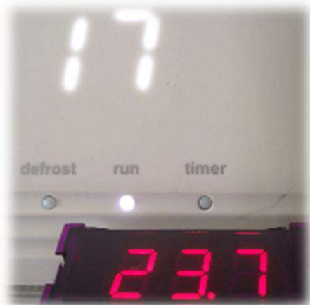
Rajah 2: Paparan bacaan suhu yang berbeza antara unit penyaman udara dan paparan panel thermostat Smart M
