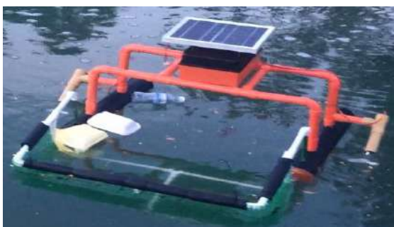
Rajah 4 : Alat bantuan inovasi mengutip sampah terapung
